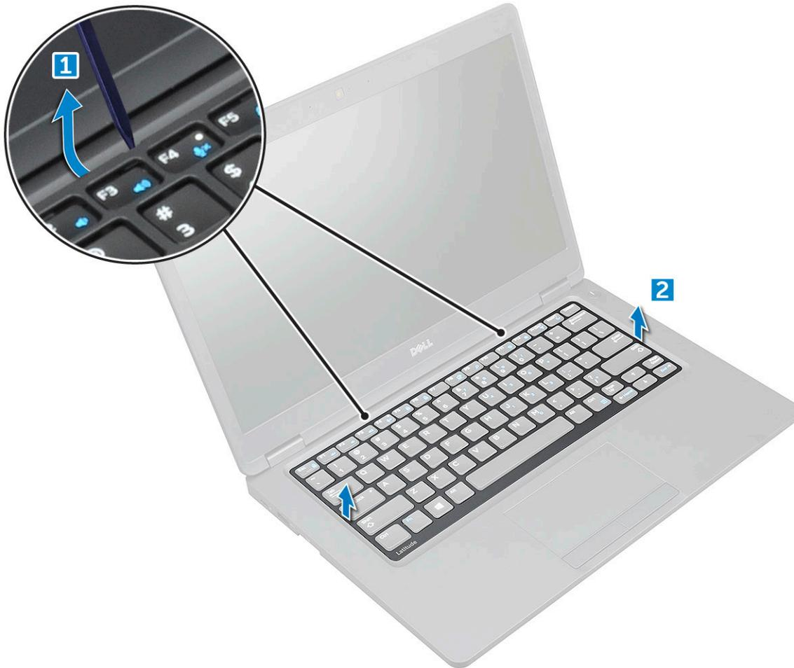
**ANMERKUNG:** Verwenden Sie einen Stift aus Kunststoff, um den Tastaturrahmen von den Kanten zu lösen.
