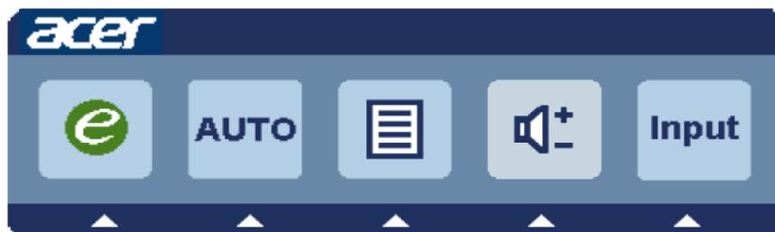
Drücken Sie zum Öffnen des Schnellzugriff-Menüs die Funktionstaste. Über das Schnellzugriff-Menü können Sie die gebräuchlichsten Einstellungen sehr schnell auswählen.
