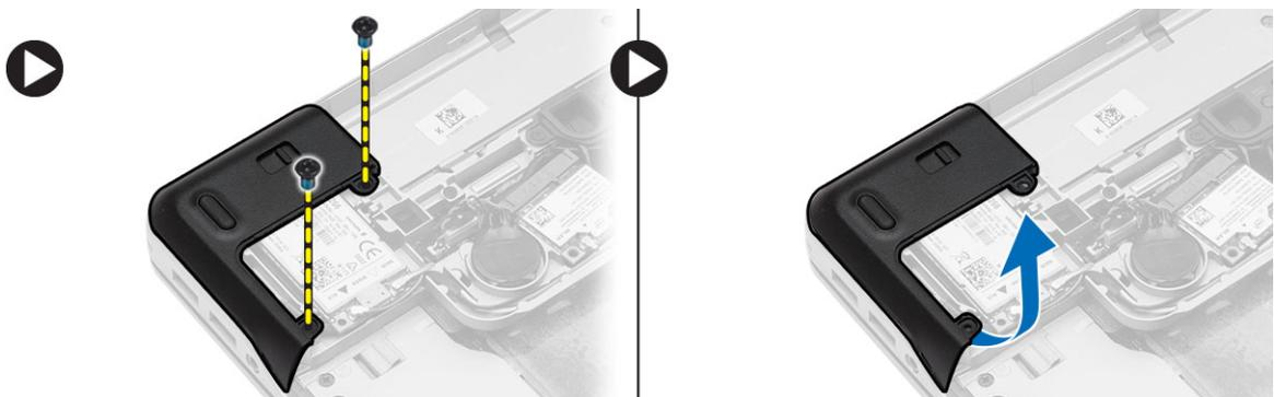
4. Entfernen Sie die Schraube, mit der die rechte Gehäuseeckenabdeckung befestigt ist, heben Sie die Abdeckung an und entfernen Sie sie vom Computer.
