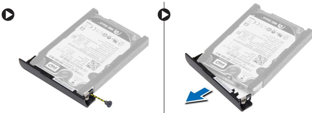
5. Biegen Sie die Festplattenisolierung. Ziehen Sie die Festplattenisolierung von der Festplatte.
