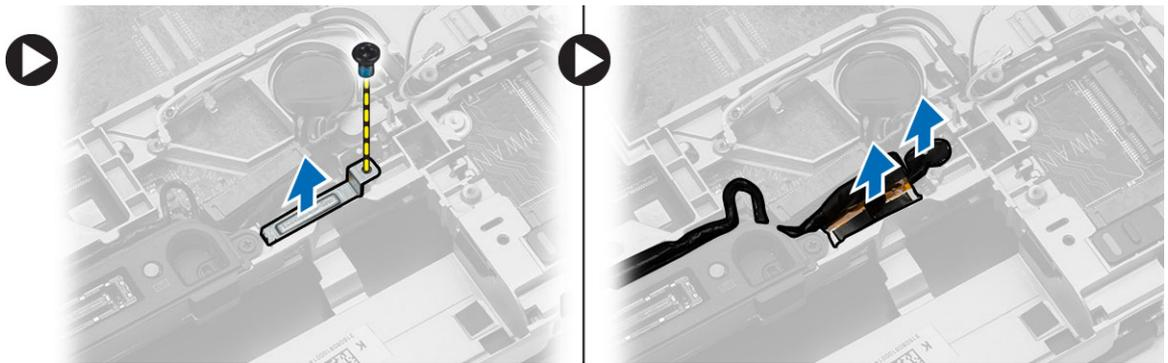
4. Lösen Sie das Kamerakabel und die LVDS-Kabel, die den Stromversorgungsanschluss am Computer befestigen, aus der Führung.
