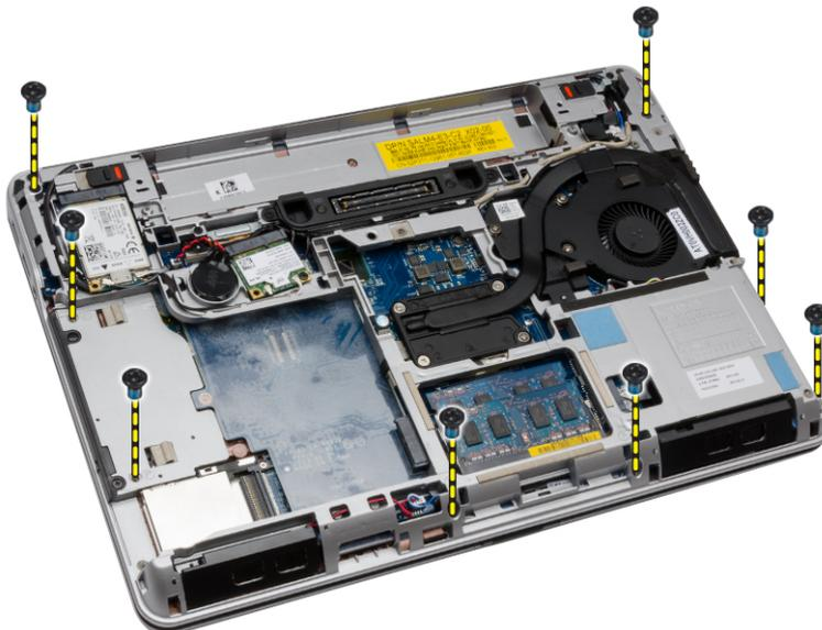
4. Drehen Sie den Computer um und trennen Sie die folgenden Kabel:
