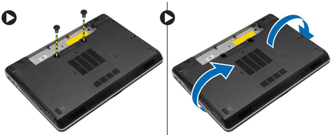
4. Entfernen Sie die Schrauben, mit denen die Tastatur an der Handballenstützen-Baugruppe befestigt ist. Heben Sie die Tastatur an und drehen Sie sie herum, um auf das Tastaturkabel zugreifen zu können.
