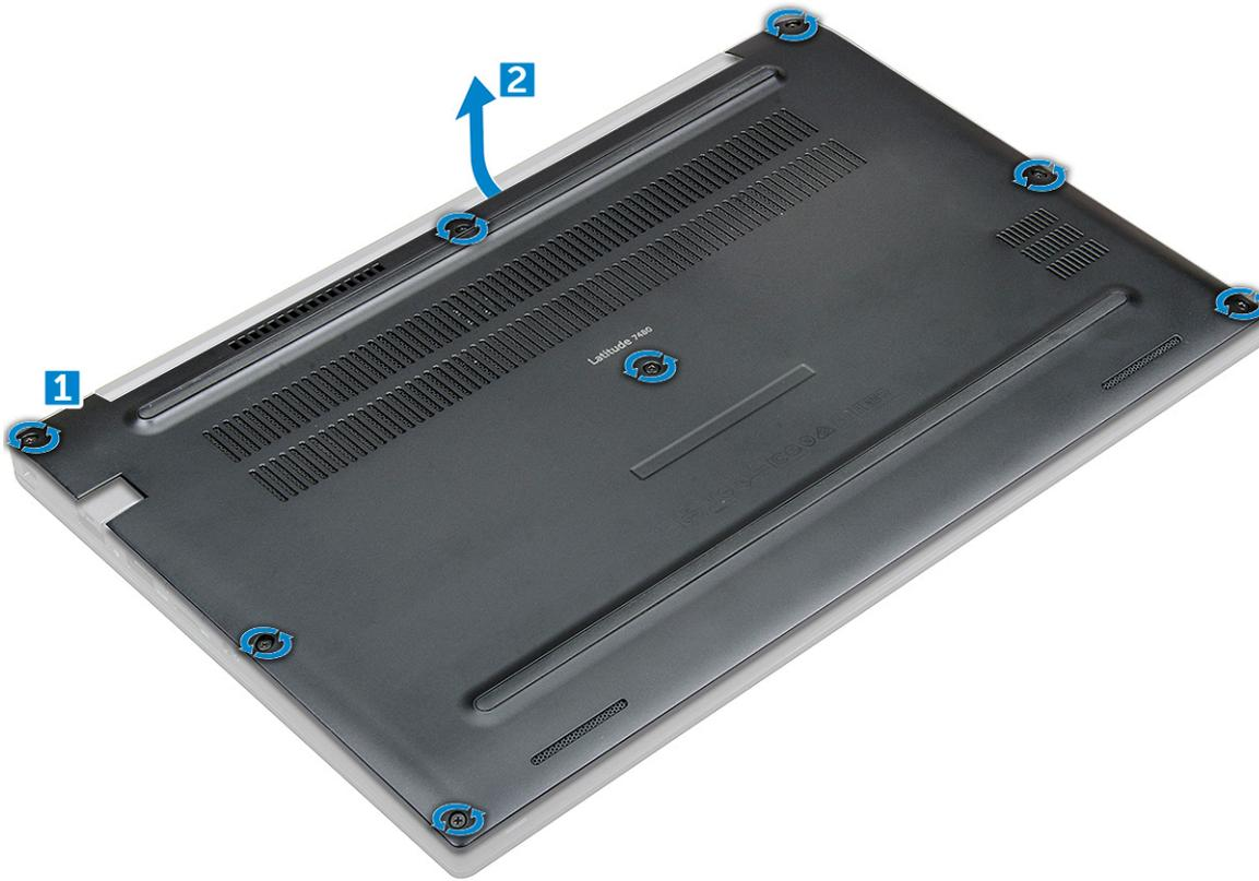
3 Heben Sie die Bodenabdeckung vom Computer.
