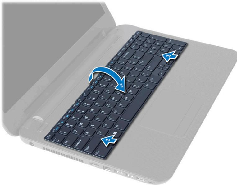
5. Trennen Sie das Tastaturkabel vom Anschluss auf der Systemplatine und heben Sie die Tastatur von der Handballenstütze.
