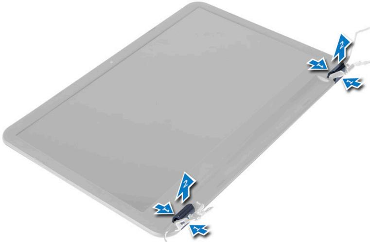
4. Hebeln Sie die Kanten der Bildschirmblende nach oben. Entfernen Sie die Bildschirmblende vom Computer.
