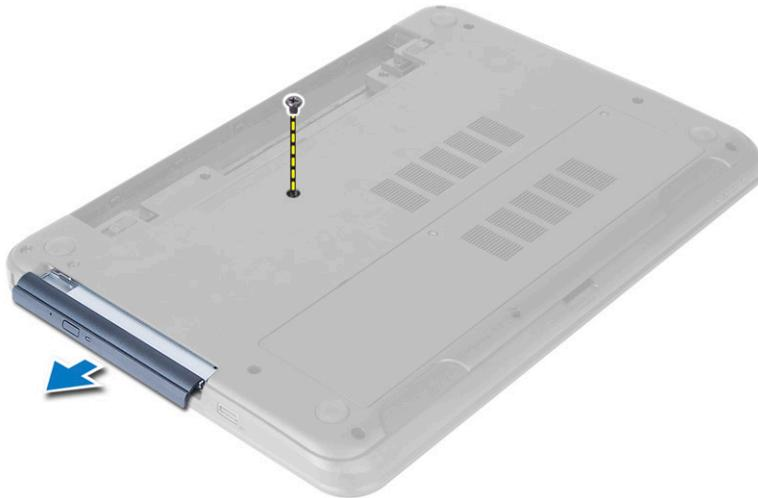
4. Drehen Sie die Schrauben heraus, mit denen die Halterung des optischen Laufwerks am optischen Laufwerk befestigt ist. Entfernen Sie die Halterung des optischen Laufwerks vom optischen Laufwerk.
