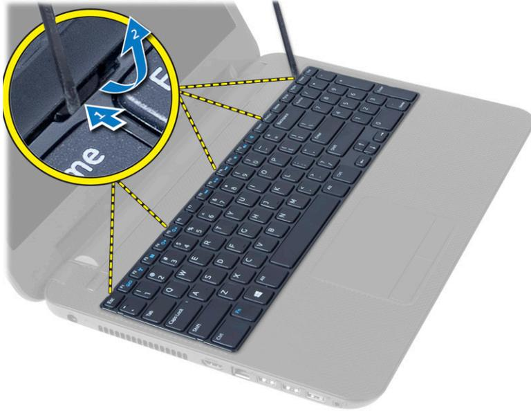
4. Schieben Sie die Tastatur in Richtung der Bildschirmbaugruppe und drehen Sie die Tastatur über der Handballenstütze um.
