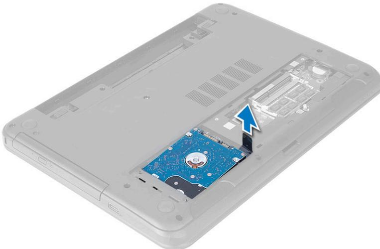
5. Entfernen Sie die Schrauben, mit denen die Festplattenlaufwerkhalterung befestigt ist. Heben Sie die Lasche an, um die Festplattenlaufwerkhalterung von der Festplatte zu entfernen.
