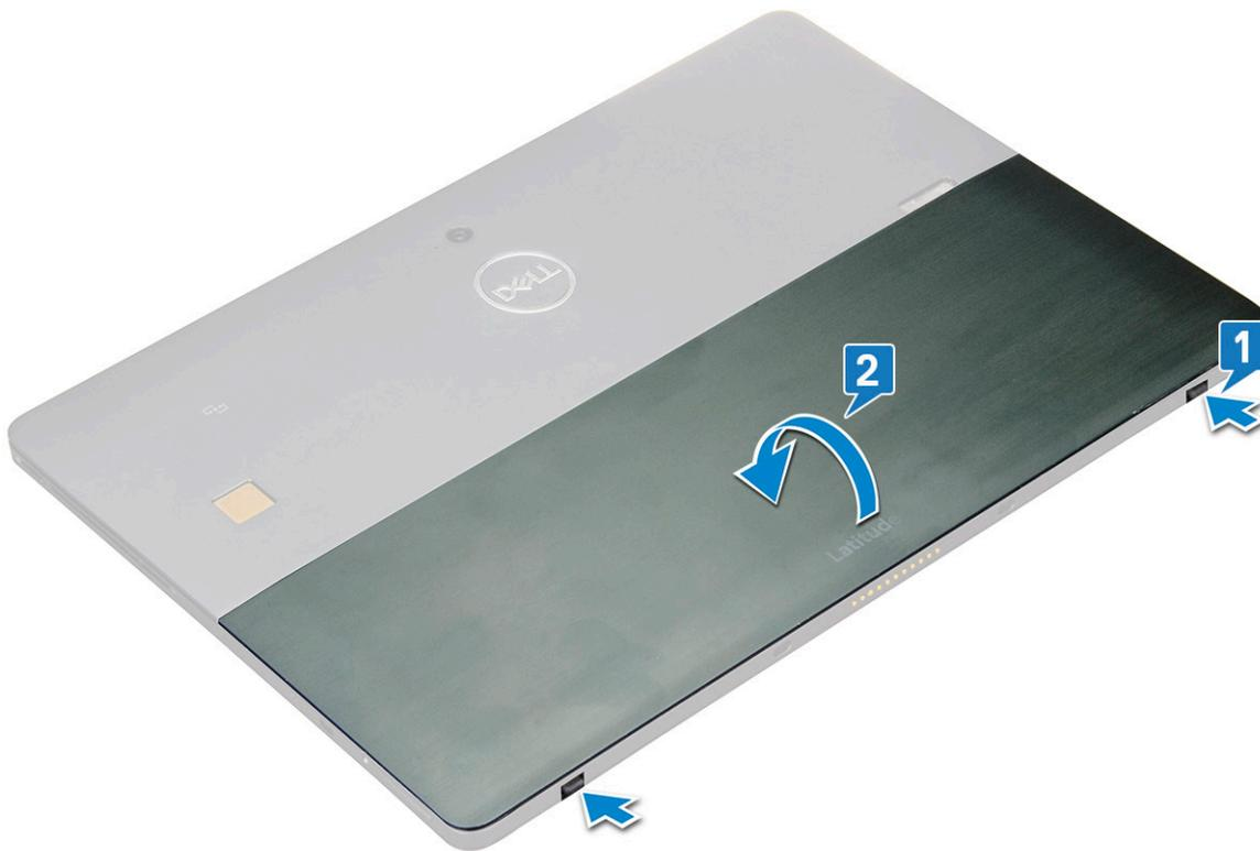
4. Öffnen Sie den Ständer auf einen Winkel von 135 Grad, sodass der microSD- und Micro-SIM-Kartensteckplatz sichtbar sind.
