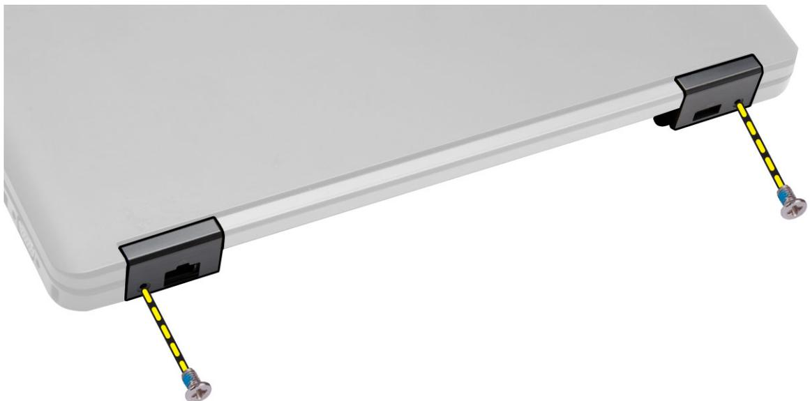
4. Entfernen Sie die Schrauben, mit denen das Bildschirmscharnier an der Vorderseite des Computers befestigt ist. Drücken Sie auf das Bildschirmscharnier und entfernen Sie es aus dem Computer.
