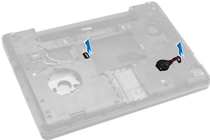
4. Drehen Sie den Computer um und ziehen Sie folgende Kabel ab:
