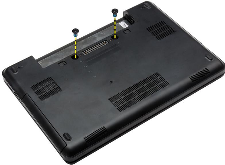
4. Entfernen Sie die Schrauben, mit denen die Tastatur [1] befestigt ist, und heben Sie die Tastatur aus dem Computer [2] und [3].
