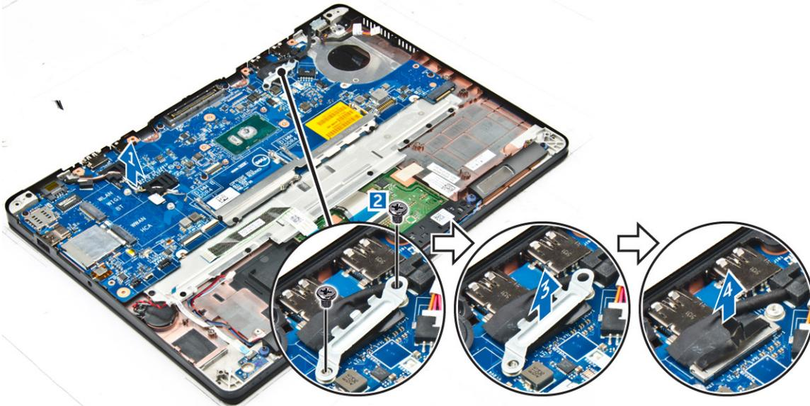
4 Trennen Sie das Lautsprecherkabel [1], das Kabel der Knopfzellenbatterie [2], das LED-Platinenkabel, das Touchpad-Kabel [3, 4] und das Kabel des Netzanschluss-Ports [5].
