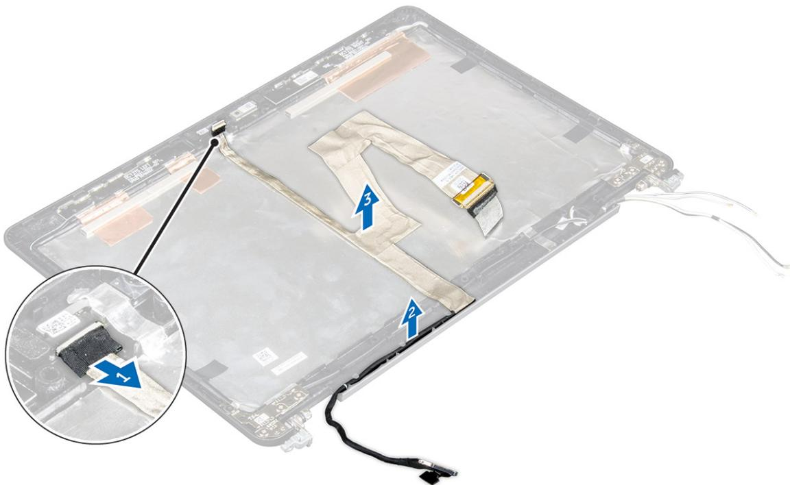
Abbildung 4. Entfernen des eDP-Kabels bei Systemen mit Touch-Funktion
