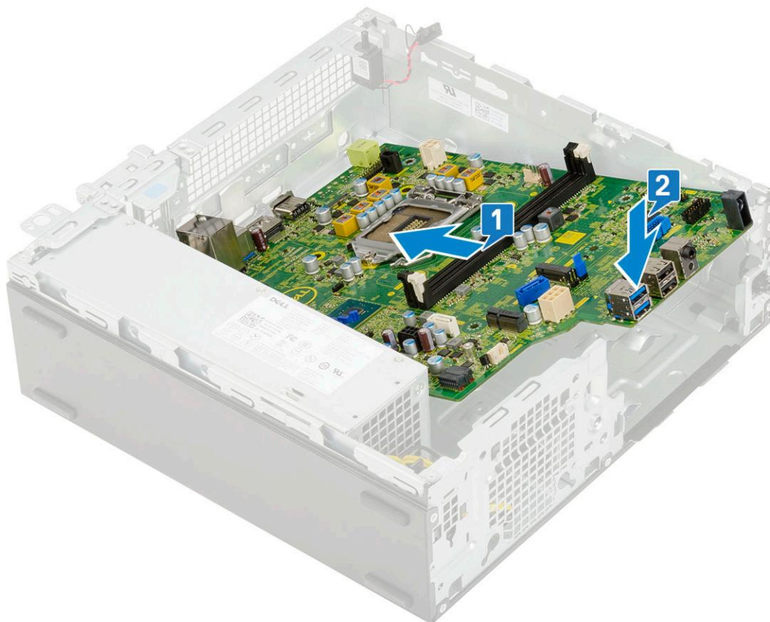
3. Bringen Sie die einzelne Schraube, die als Montagepunkt für das M.2-SSD-Laufwerk verwendet wird, die einzelne Abstandsschraube (#6-32) und die 5 Schrauben wieder an, mit denen die Systemplatine am System befestigt ist [1, 2, 3].
