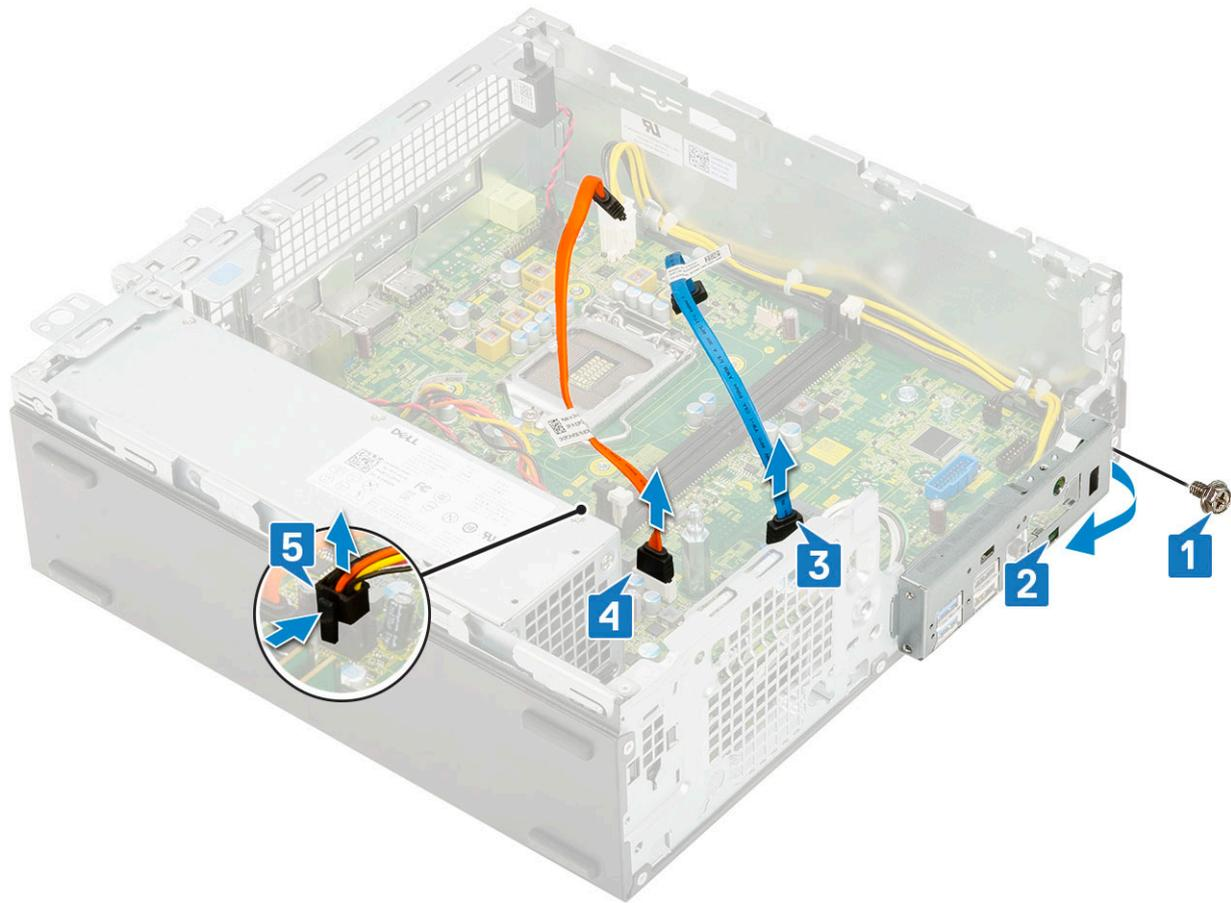
5. Trennen Sie die folgenden Kabel von den Anschlüssen auf der Systemplatine:
