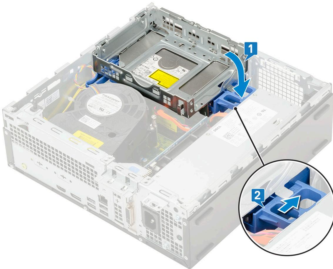
5. Führen Sie die Daten- und Netzkabel des Festplattenlaufwerks durch die HDD-ODD-Freigabelasche [1].
