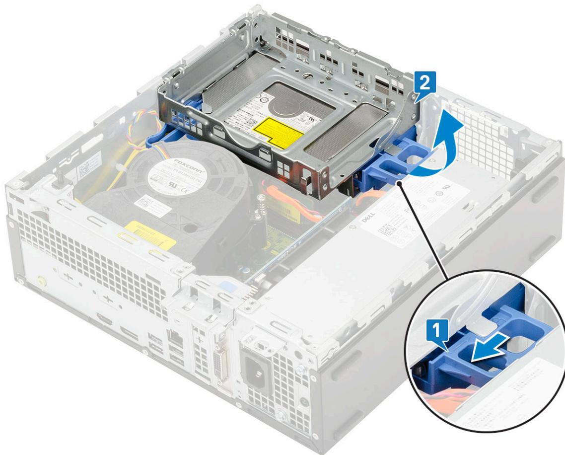
4. So entfernen Sie das Festplatten- und optische Laufwerksmodul:
