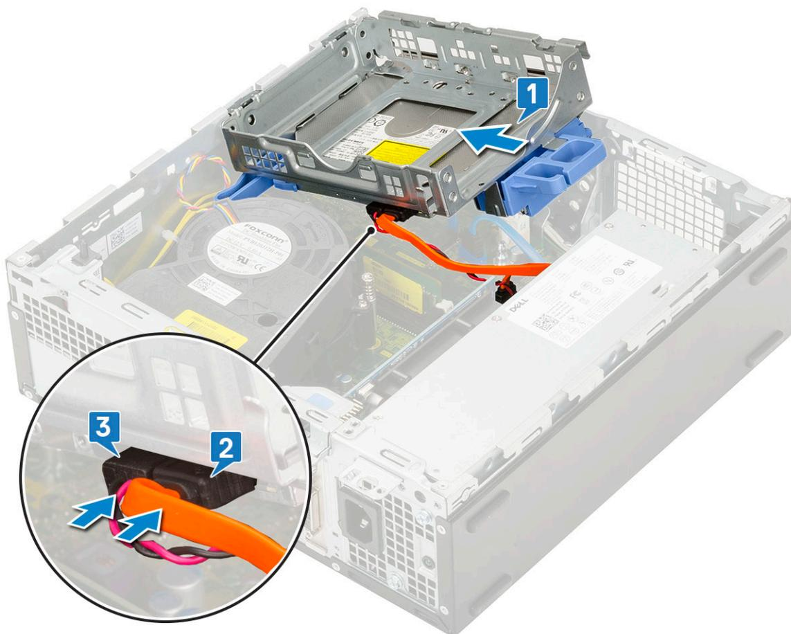
3. Setzen Sie das Festplatten- und optische Laufwerksmodul in den entsprechenden Steckplatz ein [1].
