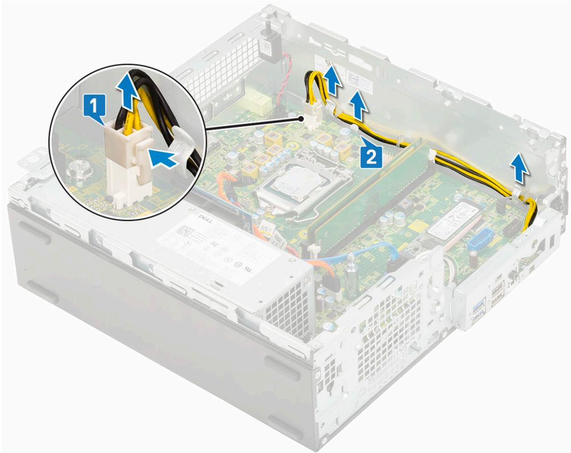
4. So entfernen Sie das Netzteil:
