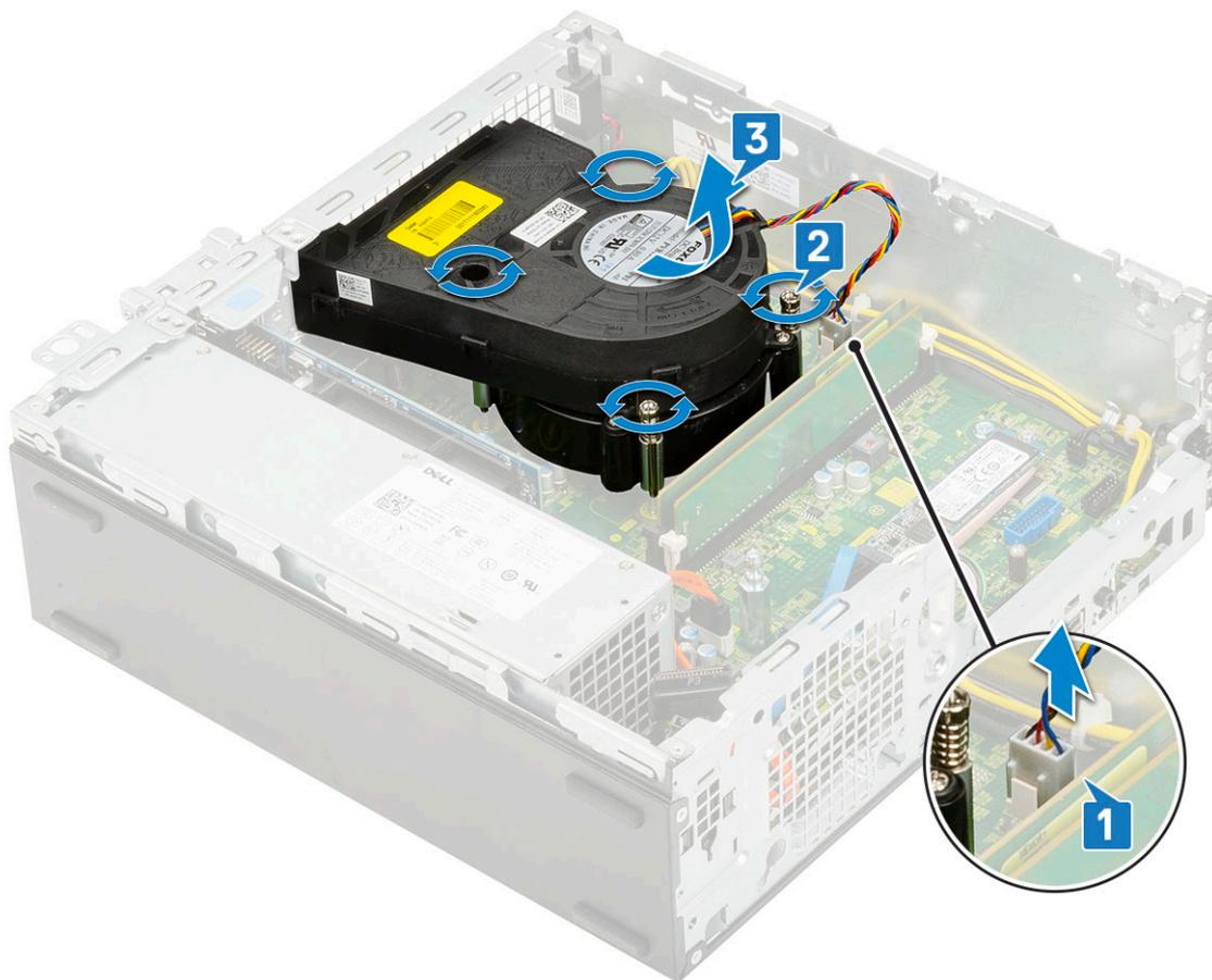
**ANMERKUNG:** Lösen Sie die Schrauben in der auf der Systemplatine angegebenen Reihenfolge (1,2,3,4).
