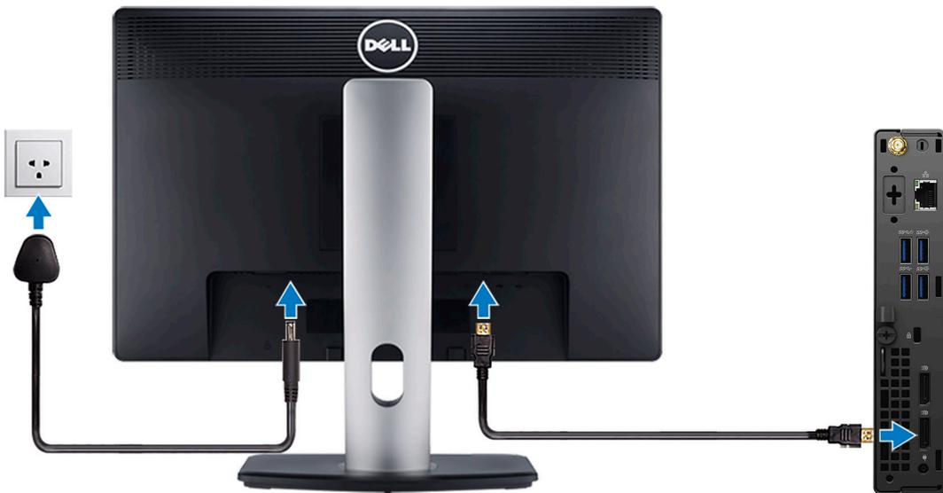
4. Schließen Sie das Stromkabel an.
