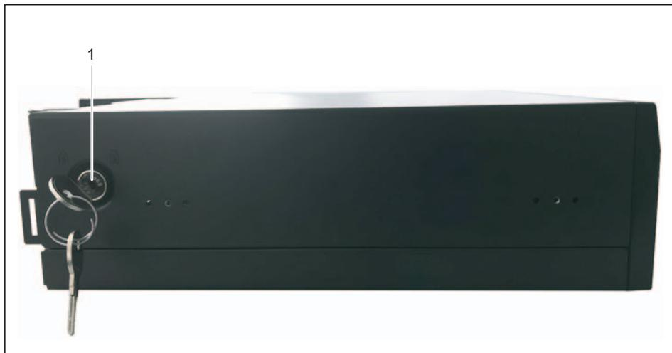
Mit dem Gehäuseschloss (1) können Sie das Gehäuse mechanisch verriegeln, um unberechtigte Personen am Öffnen des Gehäuses zu hindern. Die Schlüssel befinden sich bei Auslieferung an der Rückseite Ihres Geräts.
