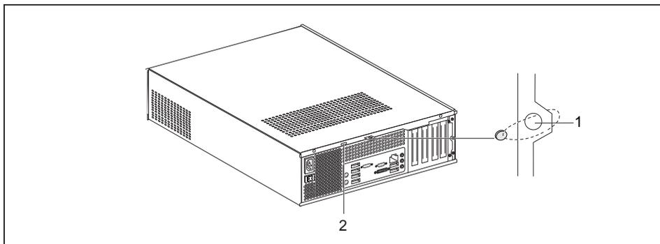
1 = Löcher für Vorhängeschloss / Verplombung    2 = Vorrichtung für Security Lock
