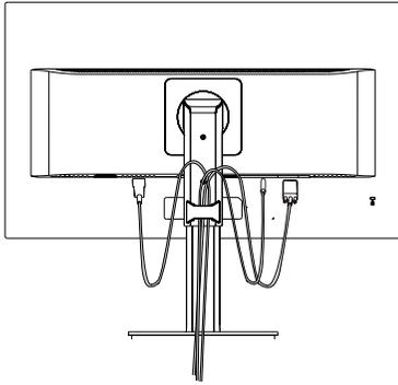
Rotieren Sie Satz (Drehpunkt) und stellen Sie Stecker. Es ist leicht, Stecker zu stellen und Kabel mit dem Kabelhalter zu verwalten.
