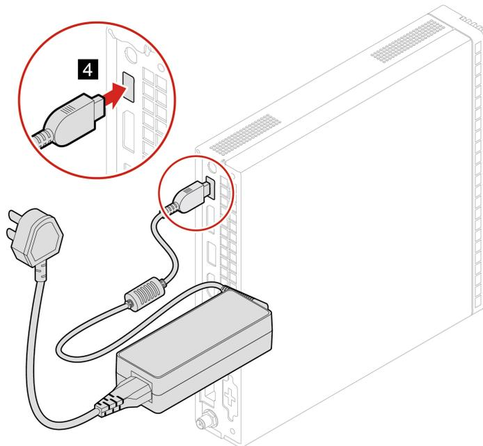
4. Schließen Sie alle externen Kabel und das Netzteil wieder an die entsprechenden Anschlüsse am Computer an.
