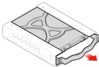
Abbildung 42. Das sekundäre 2,5-Zoll-Speicherlaufwerk aus der Halterung entfernen
