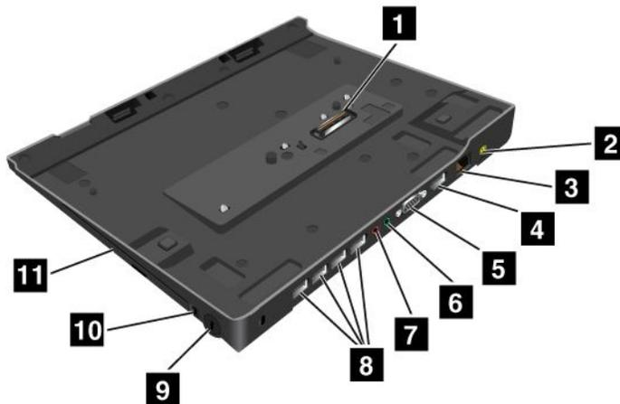
**1 Andockstationsanschluss:** Dieser dient zum Anschließen des Computers.
