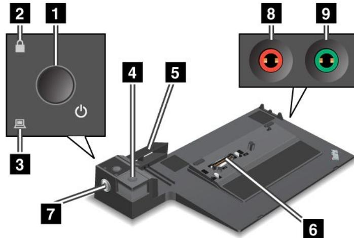
**1 Betriebsspannungsschalter:** Drücken Sie den Betriebsspannungsschalter, um den Computer ein- oder auszuschalten.
