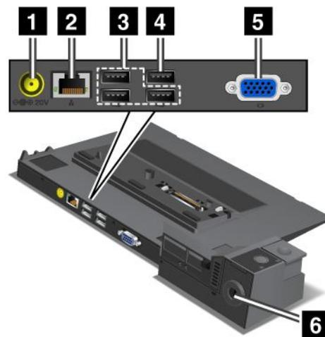
**1 Netzteilanschluss:** Schließen Sie das Netzteil an.
