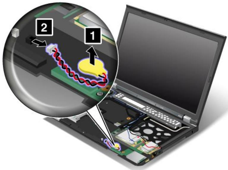
7. Setzen Sie den neuen Ersatzakku richtig ein und schließen das Kabel an.
