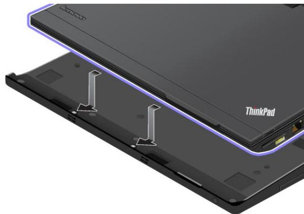
3. Achten Sie darauf, dass die Führungselemente der ThinkPad UltraBase Series 3 an den Bohrungen am Computer **1** ausgerichtet sind. Sichern Sie dann den Computer in der richtigen Position **2**. Die Andockstatusanzeige leuchtet.
