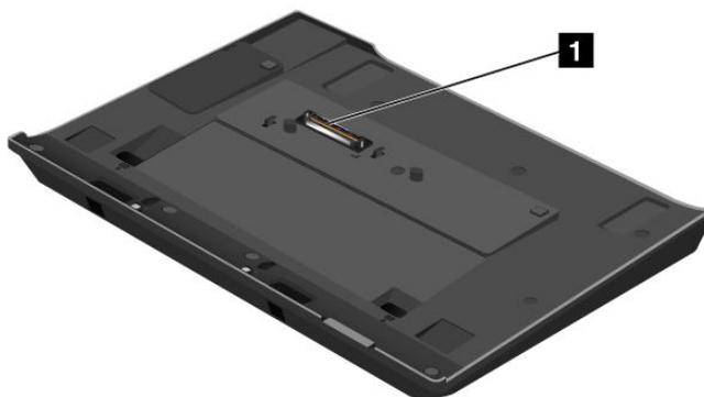
**1 Andockanschluss:** Hier wird der ThinkPad Battery 19+ an den ThinkPad-Computer angeschlossen.
