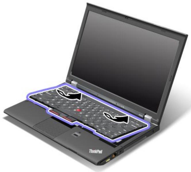
3. Drücken Sie die Tastatur vorsichtig nach unten und schieben Sie sie anschließend in die von den Pfeilen angegebene Richtung. Stellen Sie sicher, dass sich die Kanten der Tastatur unter dem Rahmen befinden.
