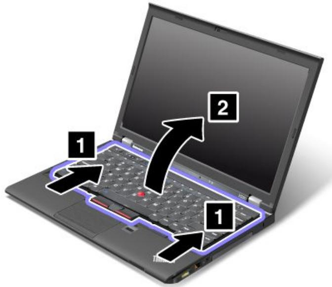
7. Heben Sie die Tastatur vorsichtig an, bis Sie sehen, wie sie angeschlossen ist. Halten Sie die Tastatur über dem Computer **1**, und ziehen Sie den Stecker ab **2**. Entfernen Sie die Tastatur.
