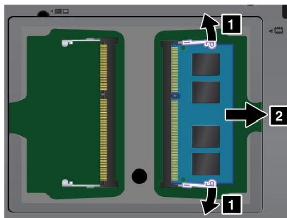
5. Stellen Sie fest, an welcher Kante des zu installierenden Speichermoduls eine Kerbe und Kontaktstifte vorhanden sind.
