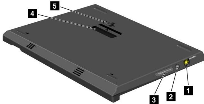
**1 Netzteilanschluss:** Hier schließen Sie das Netzteil an.
