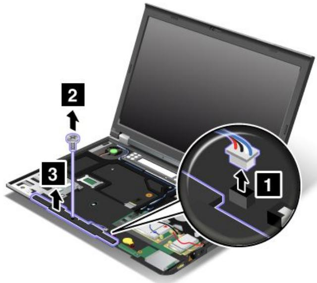
7. Setzen Sie den neuen Lautsprecher richtig ein und bringen Sie die Schraube an. Schließen Sie dann das Kabel an.
