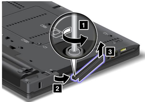
5. Entfernen Sie das Festplattenlaufwerk oder das Solid-State-Laufwerk, indem Sie an der Lasche ziehen.
