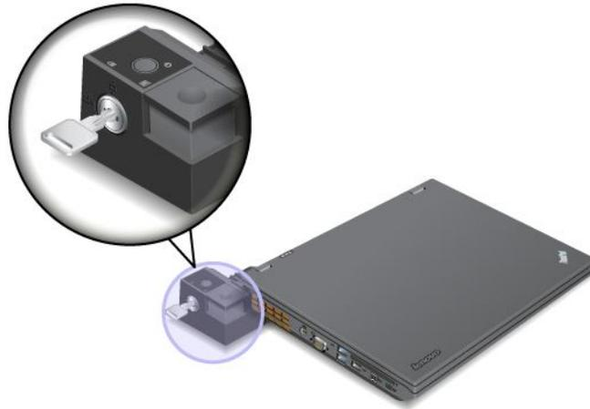
2. Drücken Sie die Entnahmetaste, bis sich der Computer nach oben bewegt. Halten Sie den Computer seitlich mit beiden Händen fest und entfernen Sie ihn.
