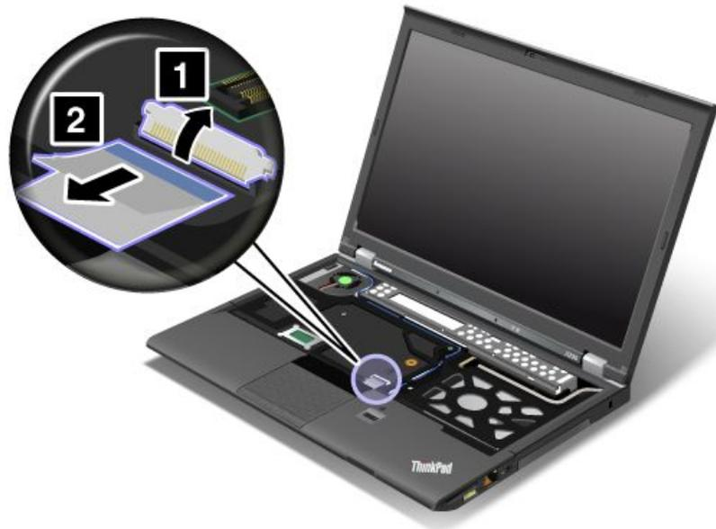
7. Heben Sie die Handauflage ab und entfernen Sie sie.
