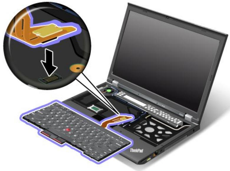
2. Setzen Sie die Tastatur ein. Stellen Sie sicher, dass sich die hinteren Kanten der Tastatur unter dem Rahmen befinden.
