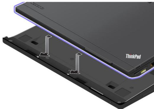
2. Stellen Sie sicher, dass die Führungselemente des ThinkPad Battery 19+ an den Bohrlöchern des Computers **1** ausgerichtet sind. Sichern Sie dann den Computer in der richtigen Position **2**.
