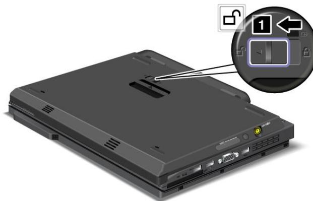
2. Lösen Sie den Ausgabelhebel **2**, um den ThinkPad Battery 19+ abzuziehen.
