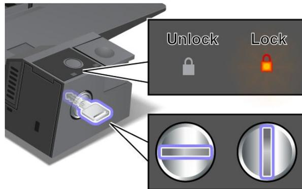
Wenn sich die Taste in der gesperrten Position befindet, ist die Entnahmetaste der Andockstation gesperrt und Sie können den Computer nicht entfernen. Wenn die Entnahmetaste gesperrt ist, leuchtet die Schlüsselsperranzeige.
