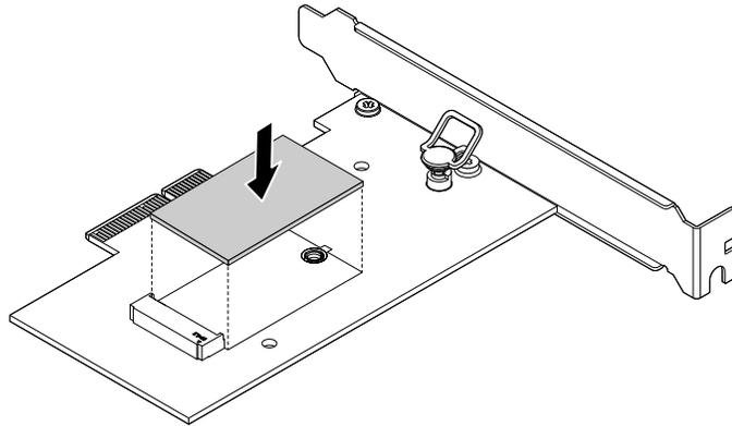
Abbildung 42. Wärmeleitpad installieren
