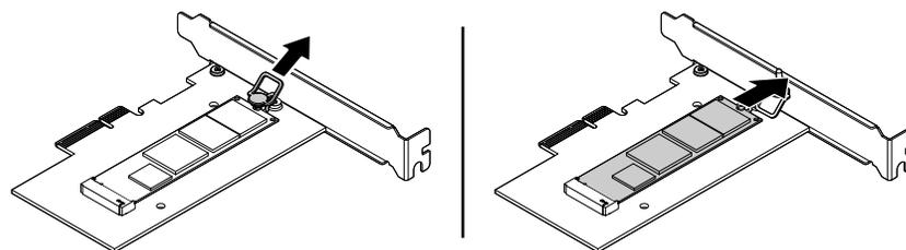
Abbildung 41. M.2-Solid-State-Laufwerk entfernen
