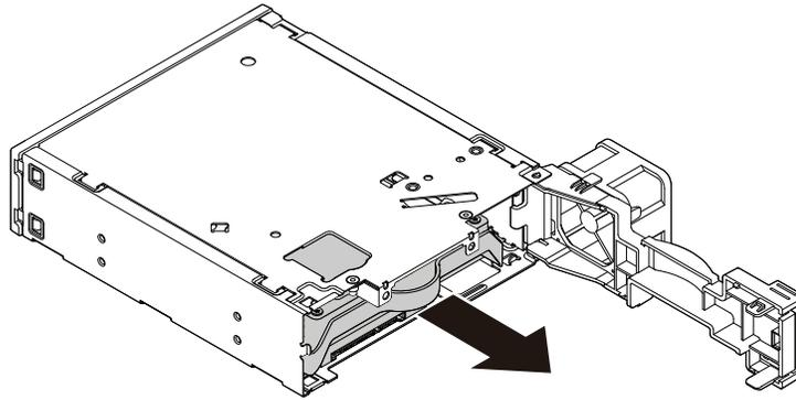
Abbildung 68. Das 3,5-Zoll-Speicherlaufwerk von der Rückseite entfernen
