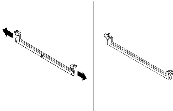
Abbildung 47. Halteklammern öffnen
