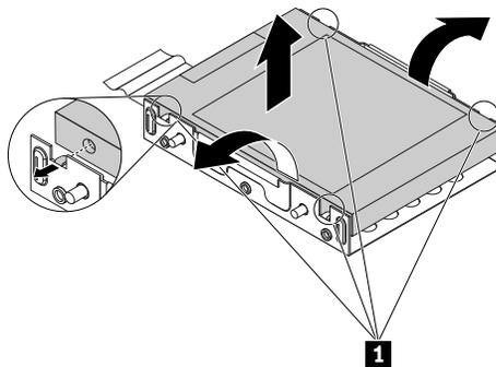
Abbildung 62. Speicherlaufwerk aus dem Adapter entfernen
