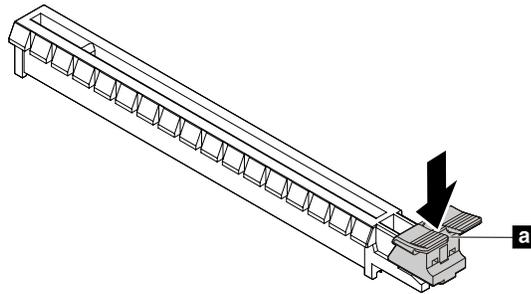
Abbildung 21. Lösen Sie den Sicherungsriegel der Karte.
