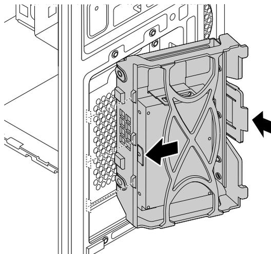
Abbildung 93. 2,5-Zoll-Speicherlaufwerk installieren
