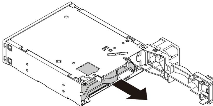
Abbildung 73. Das 2,5-Zoll-Speicherlaufwerk von der Rückseite entfernen
