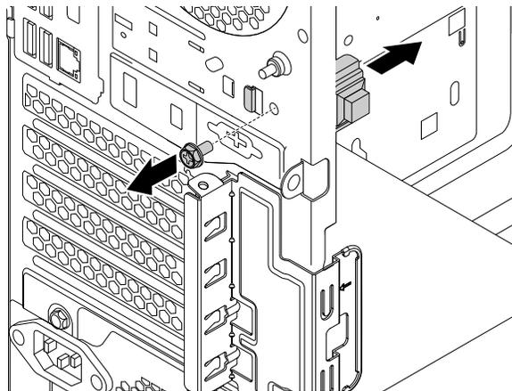
Abbildung 82. Schalter zur Abdeckungserkennung entfernen
