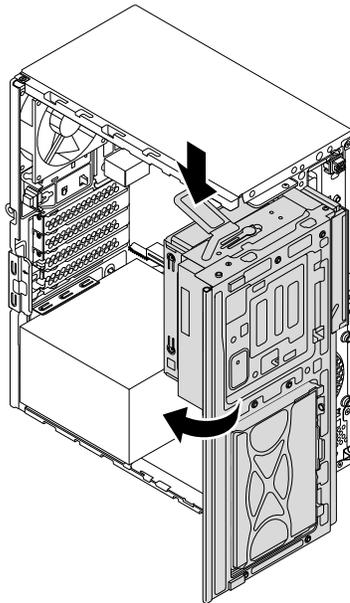
Abbildung 113. Laufwerkpositionsbaugruppe nach unten klappen
