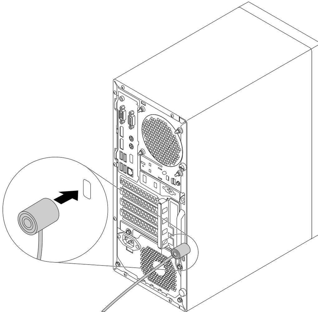
Abbildung 9. Kabelverriegelung (Kensington-Schloss)
