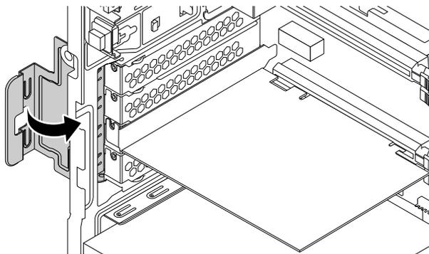
Abbildung 25. PCIe-Kartenhalterung drehen
