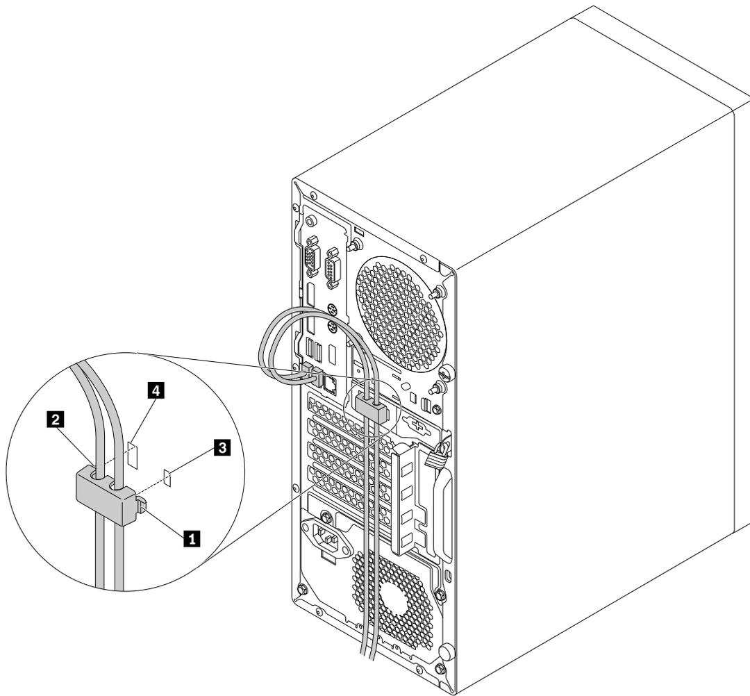
Abbildung 10. Kabelverriegelung installieren
