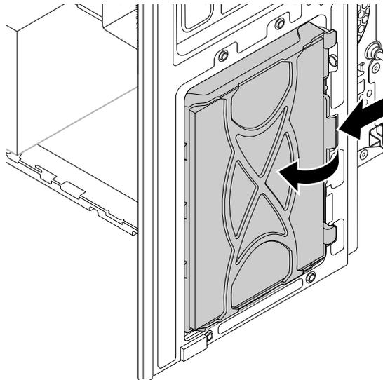
Abbildung 85. Speicherlaufwerk entfernen
