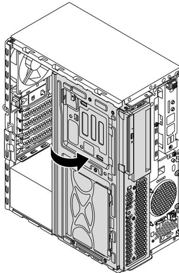
Abbildung 14. Laufwerkpositionsbaugruppe nach außen kippen
