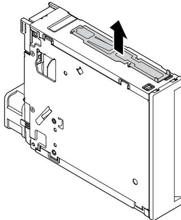
Abbildung 50. Halterung entfernen
