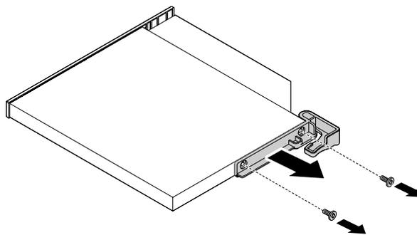
Abbildung 16. Halterung entfernen
