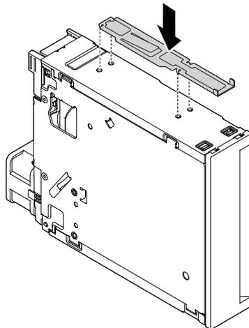
Abbildung 51. Halterung installieren
