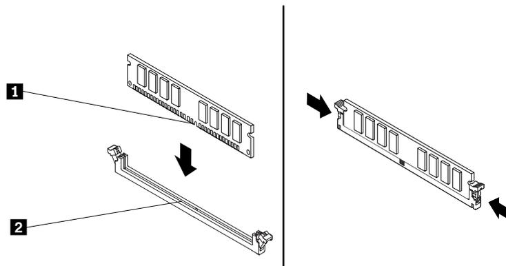
Abbildung 48. Speichermodul installieren
