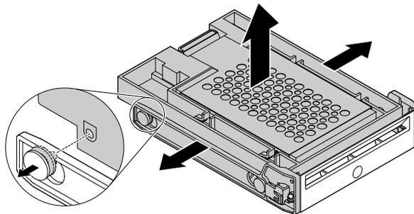
Abbildung 60. Das 2,5-Zoll-Speicherlaufwerk aus der Halterung entfernen
