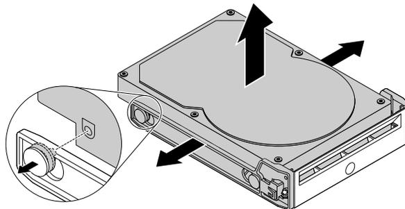
Abbildung 55. Das 3,5-Zoll-Speicherlaufwerk aus der Halterung entfernen
