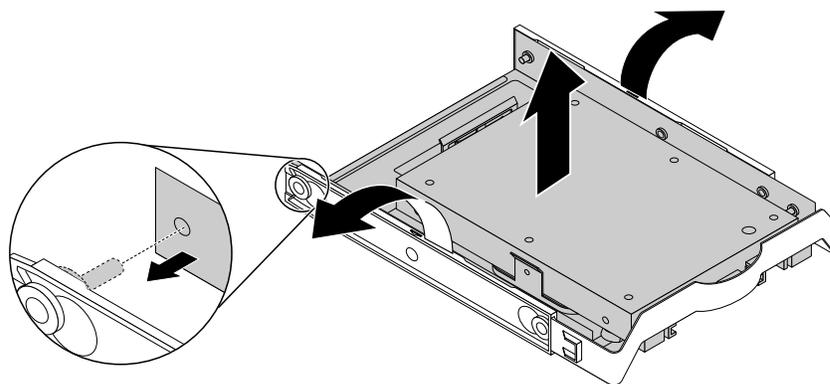
Abbildung 89. Speicherlaufwerkskonverter aus der Halterung des 3,5-Zoll-Speicherlaufwerks entnehmen
