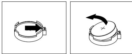
Abbildung 80. Knopfzellenbatterie entfernen
