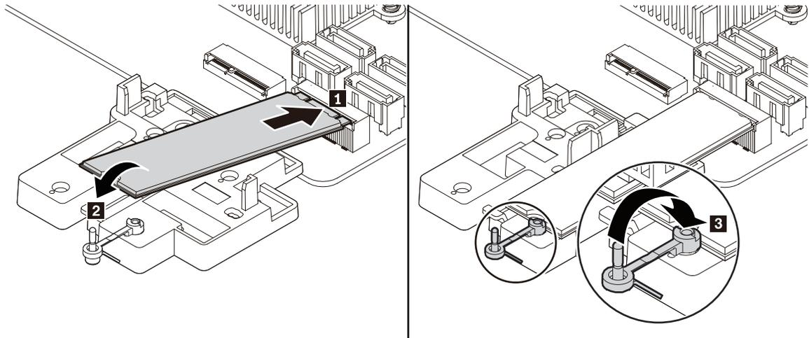
Abbildung 37. M.2-Solid-State-Laufwerk installieren
