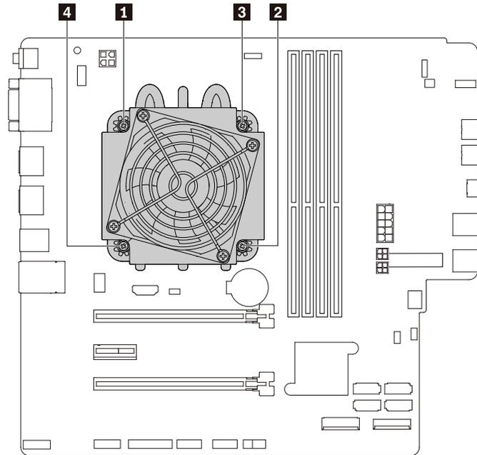
Abbildung 112. Kühlkörper- und Lüftungsbaugruppe entfernen
