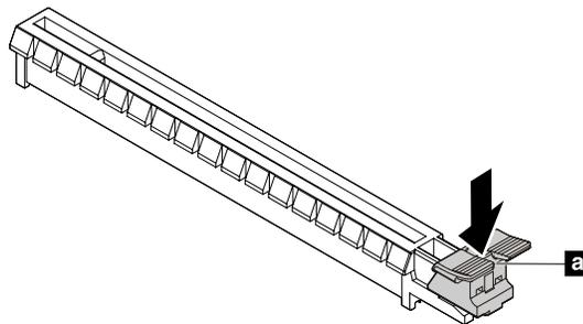
Abbildung 26. Lösen Sie den Sicherungsriegel der Karte.
