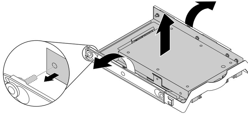
Abbildung 74. Speicherlaufwerkskonverter aus der Halterung des 3,5-Zoll-Speicherlaufwerks entnehmen
