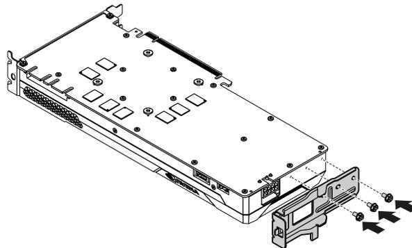
Abbildung 30. Halterung einer langen PCIe-Karte installieren
