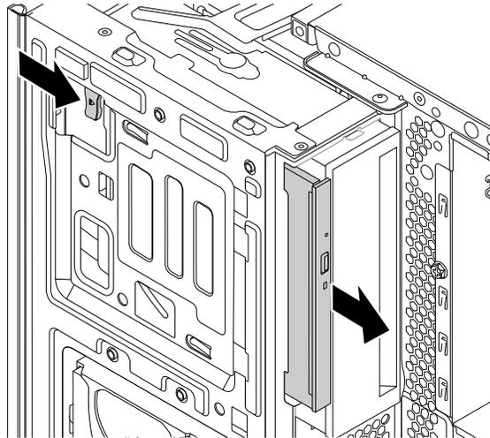
Abbildung 15. Schmales optisches Laufwerk entfernen
