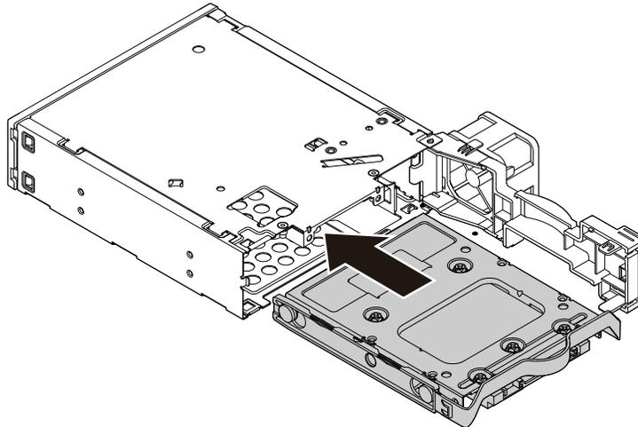
Abbildung 78. Speicherkonverter mit seiner Halterung im Gehäuse installieren
