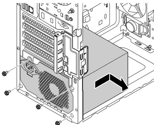
Abbildung 84. Netzteil entfernen
