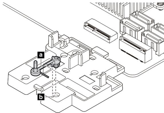
Abbildung 36. Sicherung installieren
