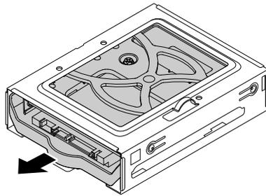
Abbildung 100. 2,5-Zoll-Speicherlaufwerk entfernen
