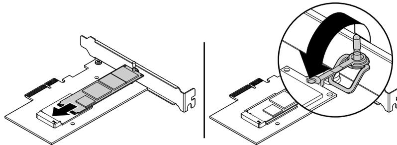
Abbildung 43. M.2-Solid-State-Laufwerk installieren
