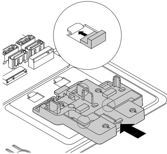
Abbildung 35. Kunststoffhalterung installieren
