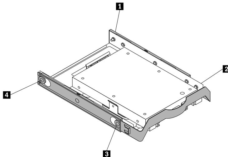
Abbildung 77. Neuen Speicherkonverter mit Solid-State-Laufwerk in der Halterung des Speicherlaufwerks installieren
