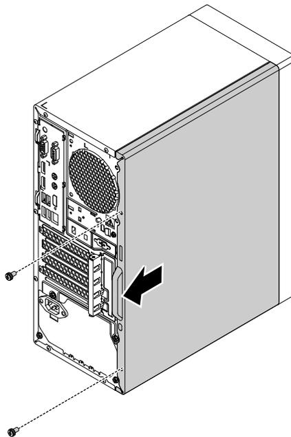
Abbildung 12. Computerabdeckung entfernen
