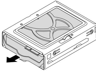
Abbildung 95. 3,5-Zoll-Speicherlaufwerk entfernen
