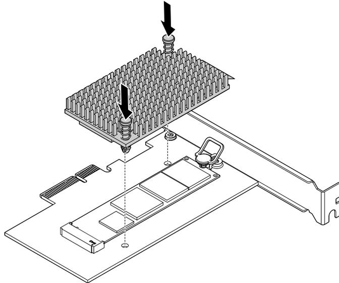
Abbildung 44. Kühlkörper installieren
