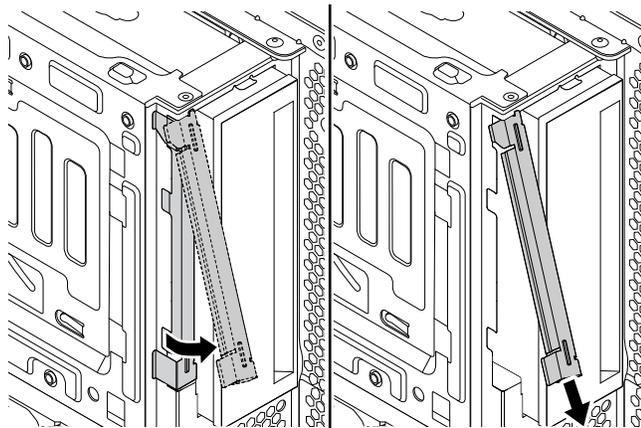
Abbildung 18. Metallblende entfernen
