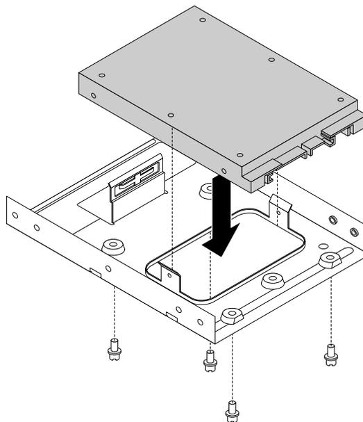
Abbildung 91. Neues 2,5-Zoll-Speicherlaufwerk in den Speicherlaufwerkskonverter einsetzen
