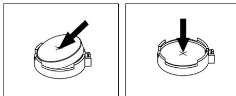
Abbildung 81. Knopfzellenbatterie installieren
