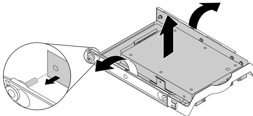
Abbildung 101. Speicherlaufwerkskonverter aus der Halterung des Speicherlaufwerks entfernen
