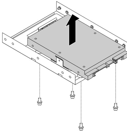
Abbildung 90. 2,5-Zoll-Speicherlaufwerk aus dem Speicherlaufwerkskonverter entfernen
