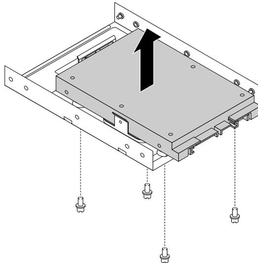
Abbildung 75. 2,5-Zoll-Speicherlaufwerk aus dem Speicherlaufwerkskonverter entfernen
