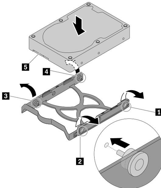
Abbildung 96. Speicherlaufwerk in der Halterung einbauen
