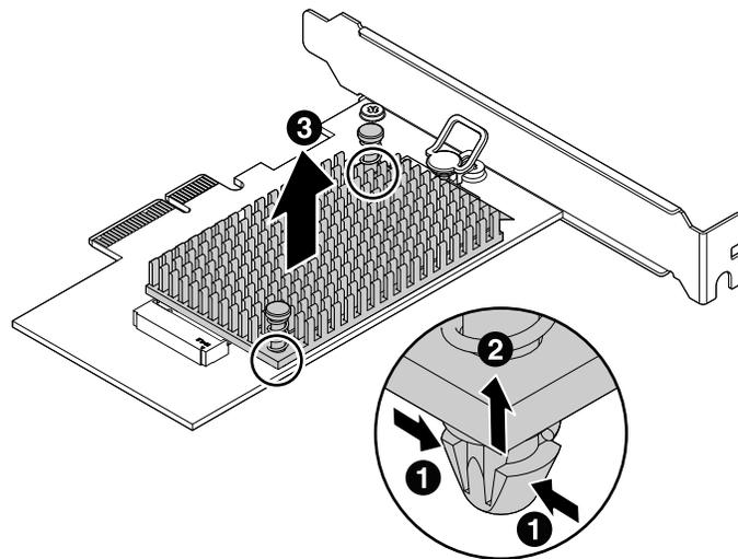
Abbildung 40. Kühlkörper vom Adapter für das M.2-Solid-State-Laufwerk entfernen
