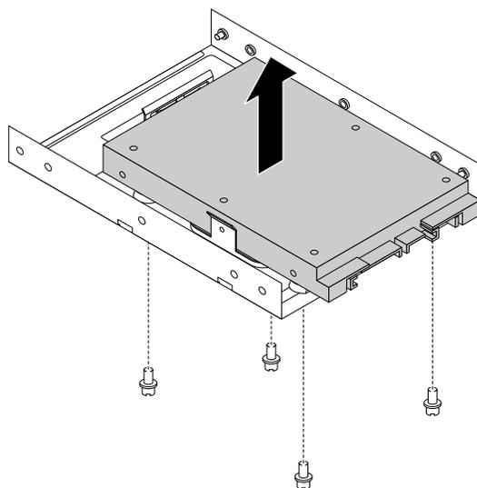
Abbildung 102. 2,5-Zoll-Speicherlaufwerk aus dem Speicherlaufwerkskonverter entfernen
