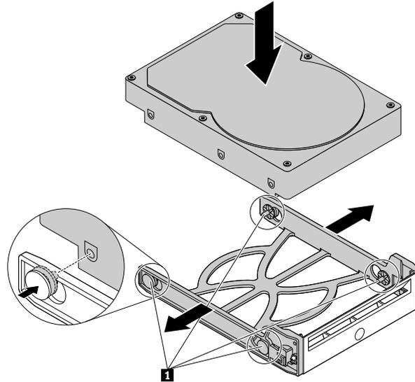
Abbildung 56. 3,5-Zoll-Speicherlaufwerk in die Halterung einbauen
