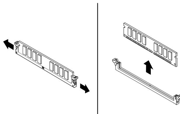
Abbildung 46. Speichermodul entfernen
