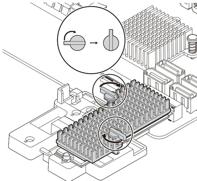
Abbildung 39. Kühlkörper an der Kunststoffhalterung befestigen
