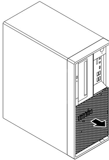
Abbildung 11. Staubschutzabdeckung entfernen
