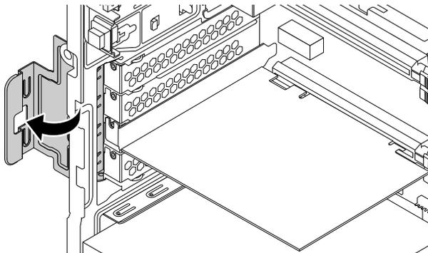
Abbildung 22. PCIe-Kartenhalterung drehen
