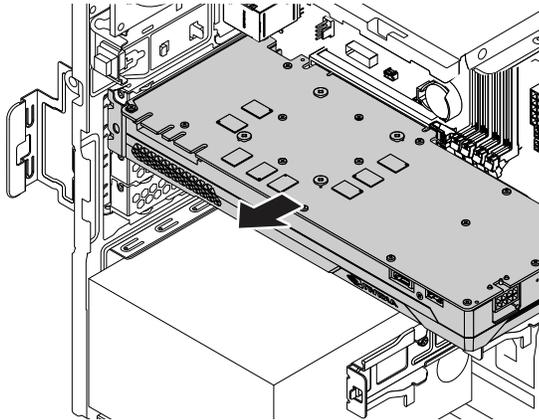
Abbildung 28. Lange PCIe-Karte entfernen
