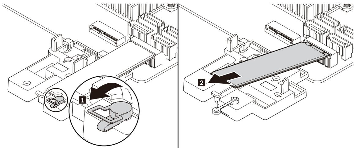
Abbildung 34. Sicherung öffnen und das M.2 Solid-State-Laufwerk entfernen
