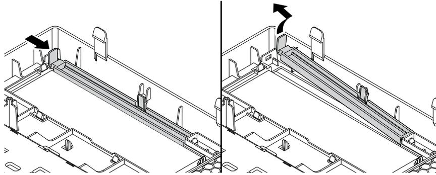
Abbildung 17. Kunststoffabdeckung entfernen
