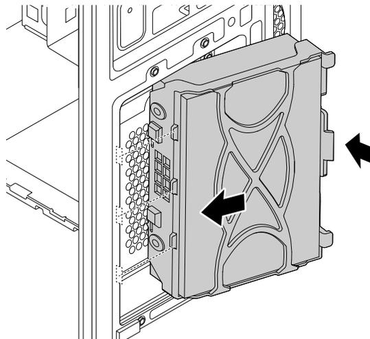
Abbildung 87. Speicherlaufwerk installieren
