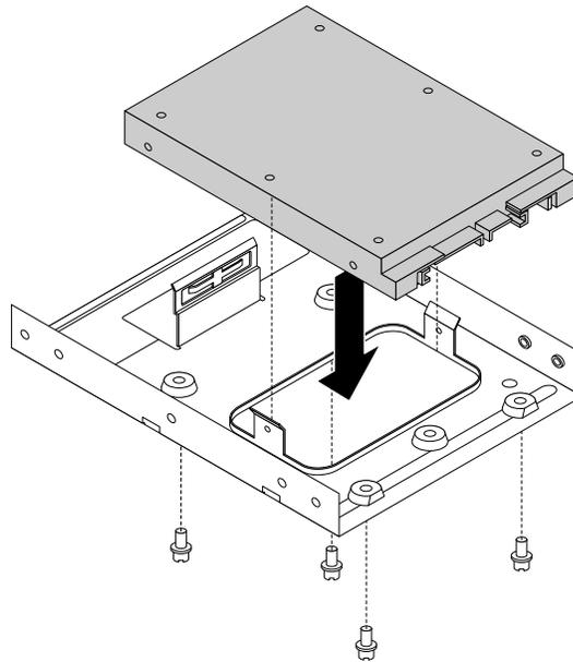
Abbildung 76. Neues Solid-State-Laufwerk im Speicherkonverter installieren
