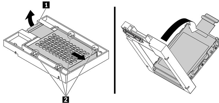
Abbildung 61. Adapter aus dem Konverter entfernen
