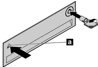
Abbildung 58. Abdeckung des Gehäuses mit Frontzugriff für die Speichereinheit öffnen
