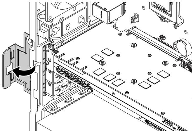
Abbildung 27. PCIe-Kartenhalterung drehen
