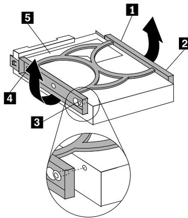
Abbildung 69. 3,5-Zoll-Speicherlaufwerk in die Halterung einbauen
