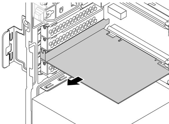
Abbildung 23. PCIe-Karte entfernen
