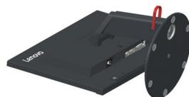
Schritt 4: Bringen Sie die Halterung aus dem VESA-Wandmontageset (100 × 100 mm Lochabstand) mit M4 x 10 mm-VESA-Montageschrauben an.
