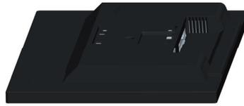
Schritt 4: Bringen Sie die Halterung aus dem VESA-Wandmontageset (100 × 100 mm Lochabstand) mit M4 x 10 mm-VESA-Montageschrauben an.
