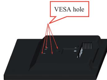
Schritt 5: Fixieren Sie den Monitor an der Wand, halten Sie sich dabei an die mit dem Wandmontageset gelieferten Anweisungen.
