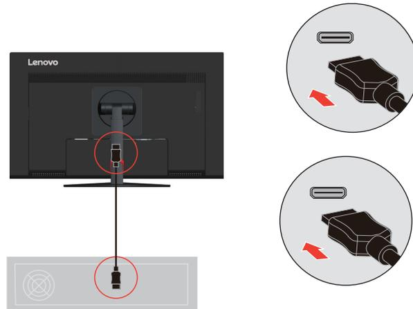
4. Verbinden Sie ein Ende des DP-Kabels mit dem DP-Anschluss an der Rückseite des Computers; schließen Sie das andere Ende am DP-Anschluss des Monitors an. Lenovo empfiehlt Benutzern, die den DisplayPort-Eingang an ihrem Monitor nutzen müssen, den Kauf des „Lenovo DisplayPort-zu-DisplayPort-Kabels 0A36537“.
