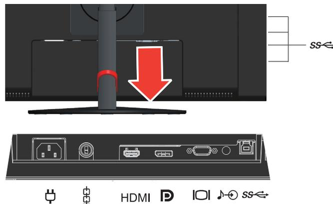
3. Verbinden Sie ein Ende des HDMI-Kabels mit dem HDMI-Anschluss an der Rückseite des Computers und das andere Ende mit dem HDMI-Anschluss am Monitor. Lenovo rät Nutzern, die den HDMI-Eingang an Ihrem Monitor nutzen müssen, zum Kauf des „HDMI-zu-HDMI-Kabels OB47070 von Lenovo“.
