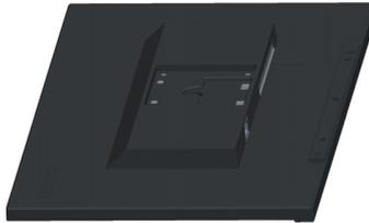
Schritt 4: Bringen Sie die Halterung aus dem VESA-Wandmontageset (100 × 100 mm Lochabstand) mit M4 x 10 mm-VESA-Montageschrauben an.
