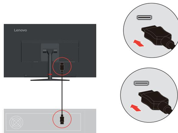
4. Verbinden Sie ein Ende des DP-Kabels mit dem DP-Anschluss an der Rückseite des Computers; schließen Sie das andere Ende am DP-Anschluss des Monitors an.
