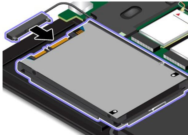
11. Setzen Sie das neue Festplattenlaufwerk bzw. das Solid-State-Laufwerk ein.
