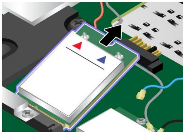
8. Richten Sie die Kante der neuen Karte für drahtlose WAN-Verbindungen mit der Einkerbung an der Aussparung des zugehörigen Steckplatzes aus. Setzen Sie dann die Karte vorsichtig in den Steckplatz ein.
