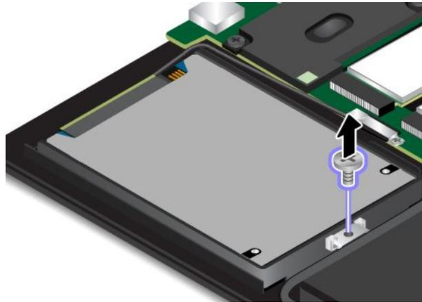
6. Heben Sie das Festplattenlaufwerk oder das Solid-State-Laufwerk leicht an.
