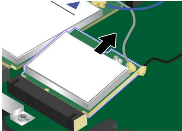
8. Richten Sie die Kante der neuen Karte für drahtlose LAN-Verbindungen mit der Einkerbung an der Aussparung des zugehörigen Steckplatzes aus. Setzen Sie dann die Karte vorsichtig in den Steckplatz ein.
