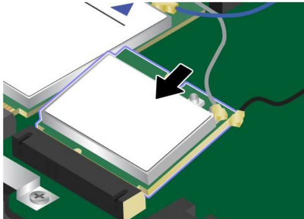
9. Klappen Sie die neue drahtlose LAN-Karte nach unten **1** und bringen Sie dann die Schraube an, um die Karte zu sichern **2**.
