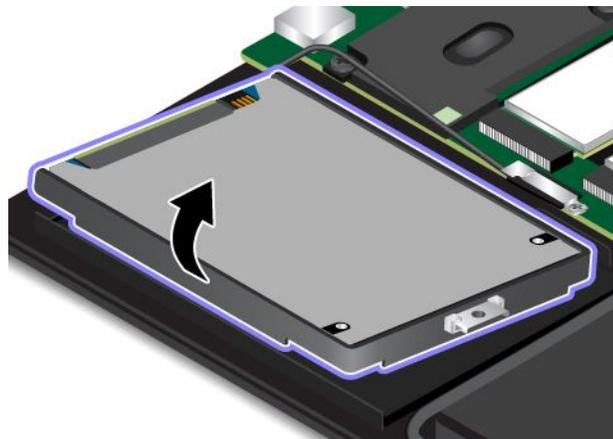
7. Trennen Sie das Laufwerkabel vom Festplattenlaufwerk oder vom Solid-State-Laufwerk.
