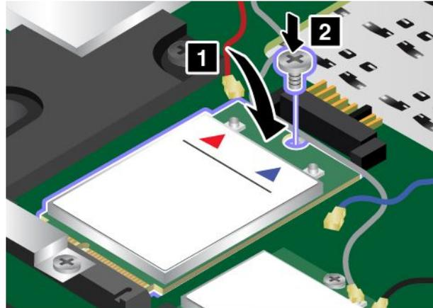
10. Schließen Sie die Antennenkabel an die neue Karte für drahtlose WAN-Verbindungen an. Stellen Sie sicher, dass das rote Kabel am Hauptanschluss der Karte und das blaue Kabel am AUX-Anschluss der Karte angeschlossen ist.
