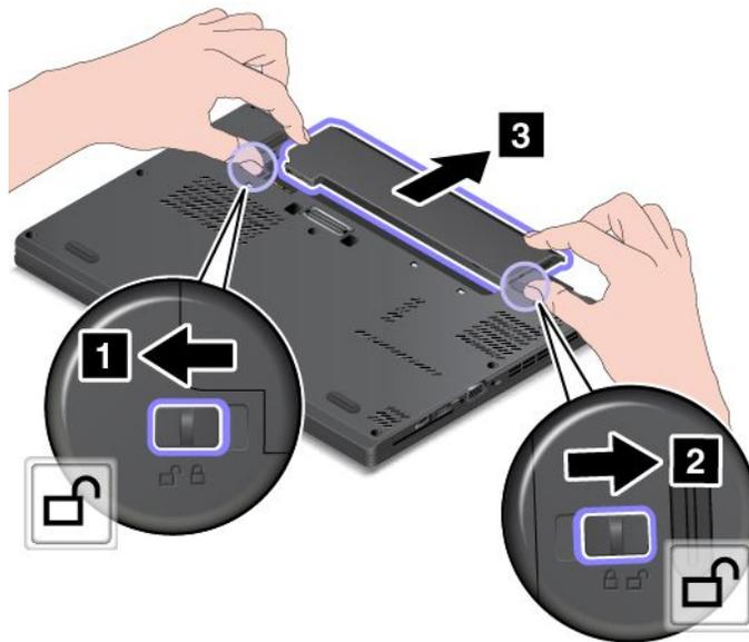
3. Legen Sie einen neuen Akku so ein, dass er hörbar einrastet. Stellen Sie sicher, dass sich die Akkuverriegelungen in der gesperrten Position befinden.
