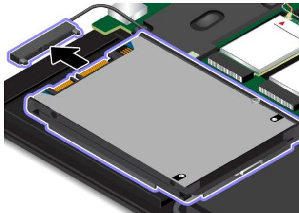
8. Entfernen Sie die Halterung des Festplattenlaufwerks oder des Solid-State-Laufwerks.
