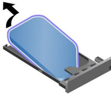
5. Installieren Sie eine neue SIM-Karte im Karteneinschub.
