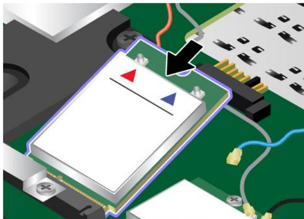
9. Klappen Sie die neue drahtlose WAN-Karte nach unten **1** und bringen Sie dann die Schraube an, um die Karte zu sichern **2**.
