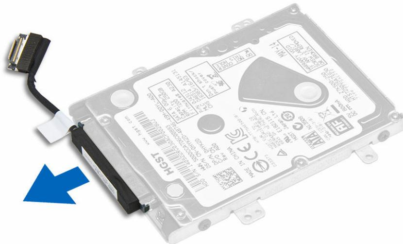
4. Entfernen Sie die Schrauben, mit denen die Festplattenlaufwerkshalterung an der Festplatte [1] befestigt ist, und entfernen Sie die Festplatte von der Festplattenhalterung [2].
